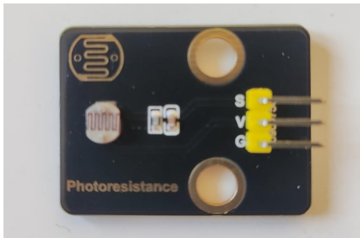
Slika 4.4 – Primijenjeni LDR foto senzor (fotografija D. Milić)
